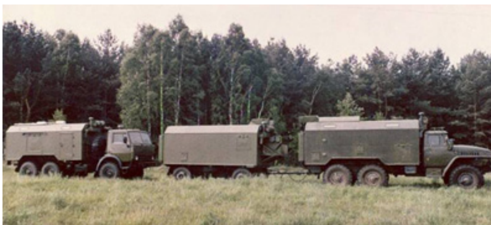
Рис. 10. Подвижный (мобильный) вычислительный комплекс РВ-2 (65с724)
