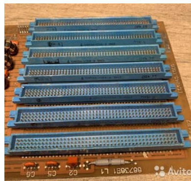
Рис. 16. Корзина для графической информации плат ПЭВМ ЕС1845. 7 позолоченных разъёмов СНП34-135В-В
