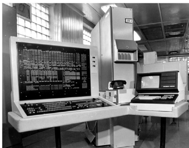
Рис. 4. Инженерный пульт МВК Эльбрус 2
