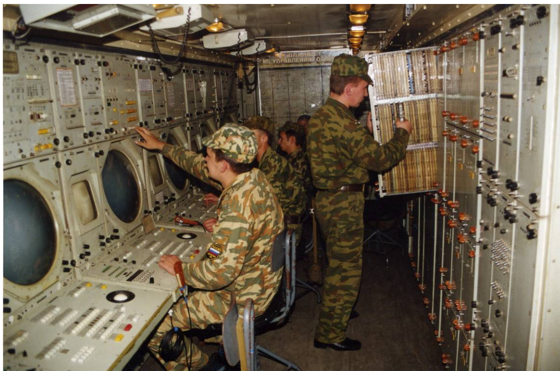
Рис. 2. ЭВМ 40У6 в составе управляющей станции С-300ПМУ1
