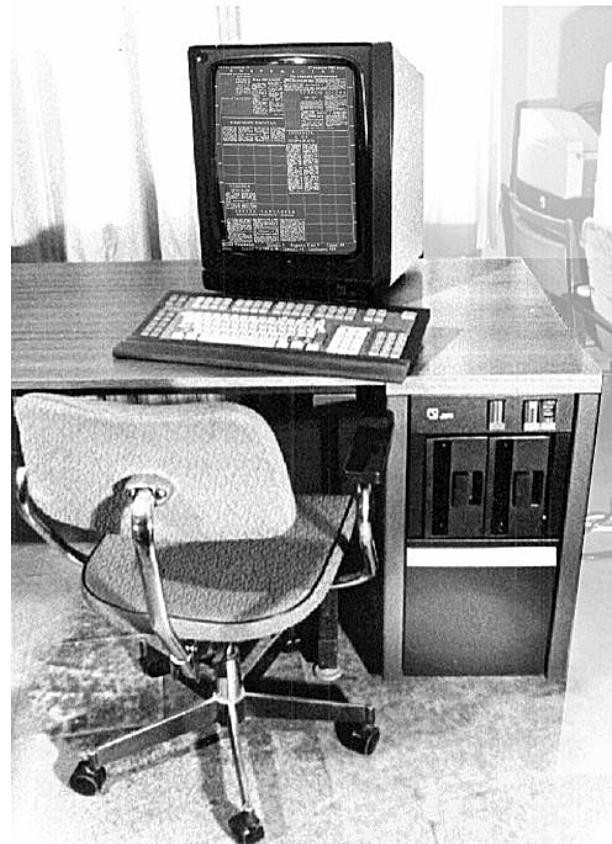
управления курсором. Пять регистрационных клавиш могут обеспечить работу в 32 регистрах по 128 символов в каждом, позволяя использовать в одном издании до 4096 разных символов. Поля клавиш выделены цветом и разделены промежутками, позволяющими разместить накладки с обозначениями функций. Для сигнализации пользователю от программ на клавиатуре есть 8 светодиодов красного, желтого и зеленого цветов, три из них совмещены с фиксируемыми в нажатом положении клавишами.
