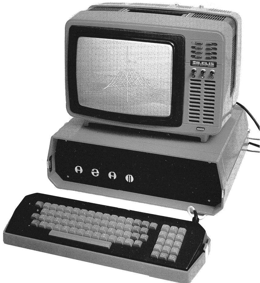
Клавиатура (74 клавиши, в том числе 15 функциональных) выполнена в виде отдельного блока, соединенного с системным блоком последовательным каналом. При транспортировке клавиатура пристегивалась к системному блоку, и все это было удобно переносить благодаря имеющейся там ручке. В АГАТ-4 появляется внутренняя шина, на которой находятся семь шестидесятиконтактных разъемов.
