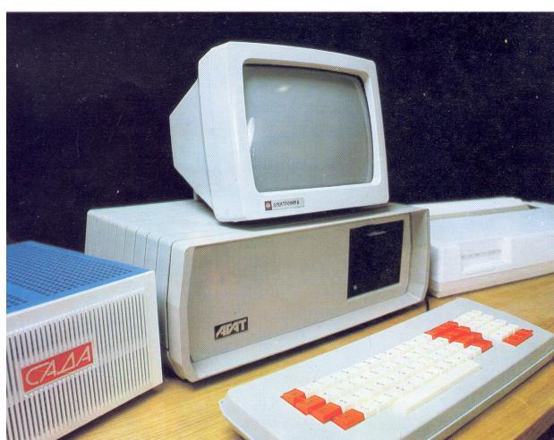
Наличие шести свободных разъемов на генплате открывало широкое разнообразие конфигураций ПЭВМ АГАТ-9. Минимальная конфигурация (базовый комплект) включала монохроматический дисплей МС 6105, НГМД емкостью 840 Кбайт и программное обеспечение в объеме инструментального комплекса программиста – ИКП-1: интерпретатор языков «Бейсик», «Рапира», «Школьница», дисковая операционная система, тестовое обеспечение, система копирования.
